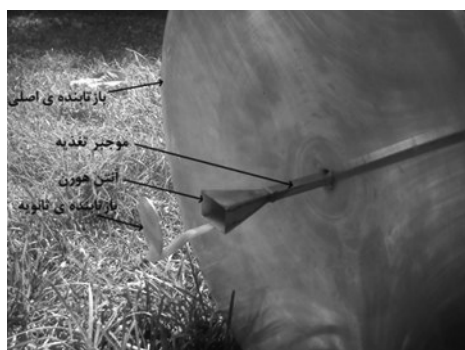
شکل (۱۴). شمای آنتن ساخته شده در آزمایشگاه
