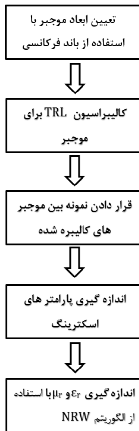
شکل (۱): مراحل کلی اندازه‌گیری مشخصات الکترومغناطیسی به روش موجبر مستطیلی [۱۰]
