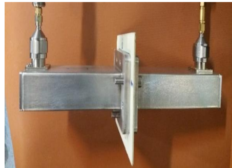
شکل (۱۹): قرار گرفتن نمونه RO3003 با ضخامت ۱/۵ mm بین دو موجبر برای کالیبراسیون TRL جهت اندازه‌گیری مشخصات الکترومغناطیسی ماده با موجبر مستطیلی
