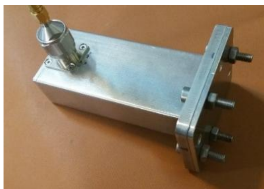
شکل (۱۶): نحوه اتصال کوتاه کردن موج‌بر در حالت انعکاس از کالیبراسیون TRL
