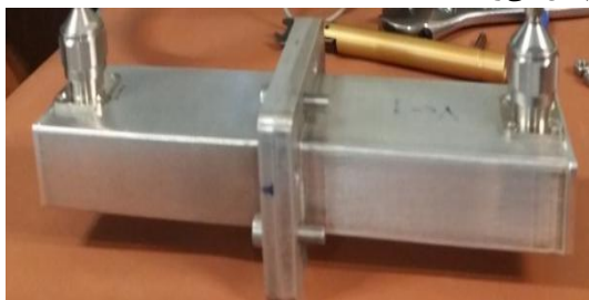
شکل (۱۷): نحوه اتصال دو موج‌بر بهم در حالت مستقیم برای به‌دست آوردن الگوریتم TRL جهت اندازه‌گیری مشخصات الکترومغناطیسی ماده با موج‌بر مستطیلی
