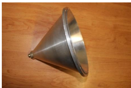
شکل (۱۱): حد واسط بین کانکتور و لنز
