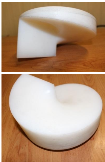
شکل (۳): لنز ساخته شده از تفلون در دو نمای مختلف
