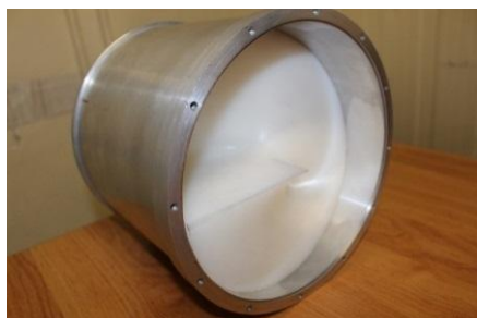
شکل (۱۰): لنز آنتن و چگونگی قرارگیری آن در نگاه‌دارنده
