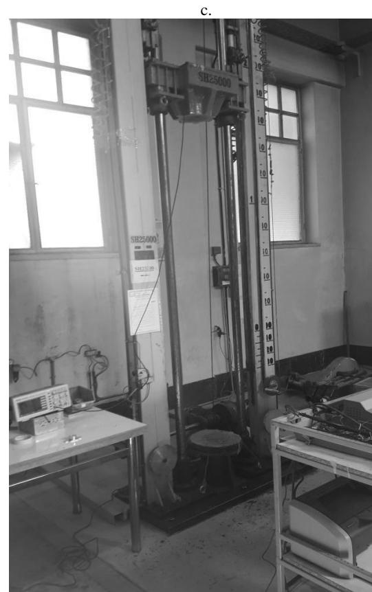
شکل (۱۲): دستگاه تست شوک به همراه مونتاژ ژنراتور الکترومغناطیسی مینیاتوری بروی آن.
