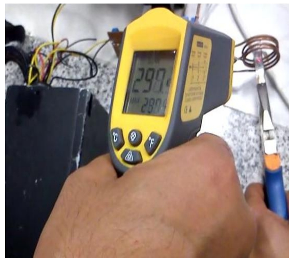
شکل (۲۰): دمای فلز درون گرم‌کن.
