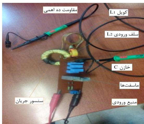
شکل (۲۲): گرم‌کن القایی به همراه حسگر جریان.
