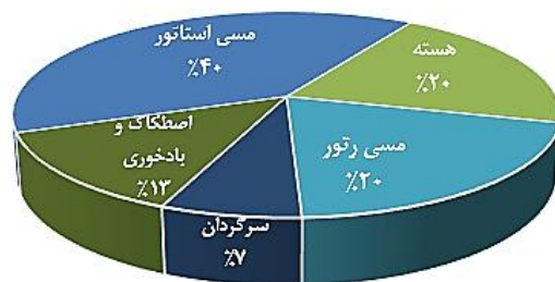
شکل (۱): توزیع تلفات در موتور القایی [۱۱]
