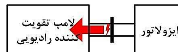
شکل (۲): برگشت توان از دهانه موجبری خروجی به لامپ به دلیل شکست الکتریکی.
