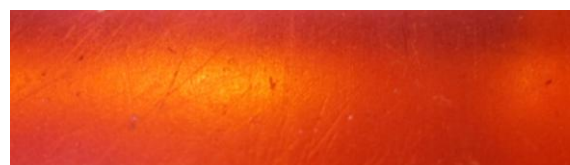
شکل (۱۰): ساختار بلوری سطح موجبر مسی خروجی لامپ سالم که تحت خطای برگشت توان قرار نگرفته است.
