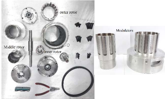
شکل (۱۴): قطعات تشکیل‌دهنده گیربکس مغناطیسی سه سرعت.
