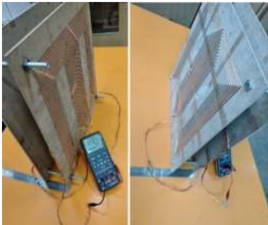
شکل (۱۲): اندازه‌گیری اندوکتانس تزویج پدهای آزمایشگاهی DD
