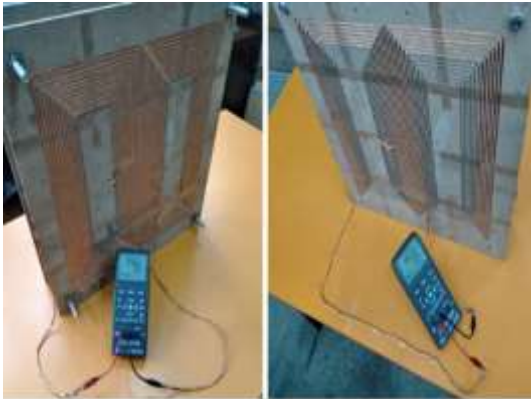
شکل (۱۱): اندازه‌گیری عملی اندوکتانس خودی پدهای DD
