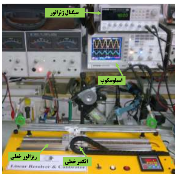
شکل (۹): مدار آزمون عملی ریزالور خطی
