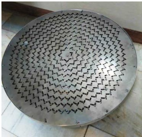
شکل (۱۹). ساختار آنتن آرایه‌ای شکافدار خطی شعاعی توان بالا در فرکانس ۹/۴۵ گیگاهرتز
