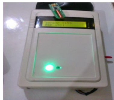
شکل (۳): مغناطیس سنج FLC100 طراحی و ساخته شده مورد استفاده برای آزمایش
