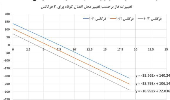
شکل (۲۴). نمودار تغییرات فاز S_{21} تغییردهنده فاز نسبت به تغییر محل اتصال کوتاه برای ابتدا، وسط و انتهای باند فرکانسی
