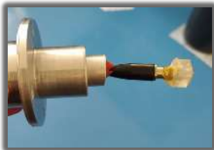
شکل (۴): حسگر فیبر نوری فابری-پرو با لایه PU
