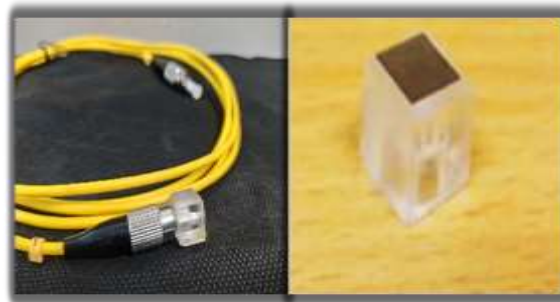
شکل (۲): سمت راست: نمونه‌ای از لایه ساخته شده، سمت چپ: لایه قرارگرفته روی فیبر نوری
