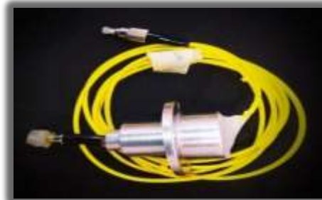
شکل (۵): حسگر فیبر نوری فابری-پرو با لایه Rigid PVC
